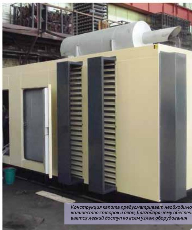
*Конструкция капота предусматривает необходимое количество створок и окон, благодаря чему обеспечивается легкий доступ ко всем узлам оборудования*
