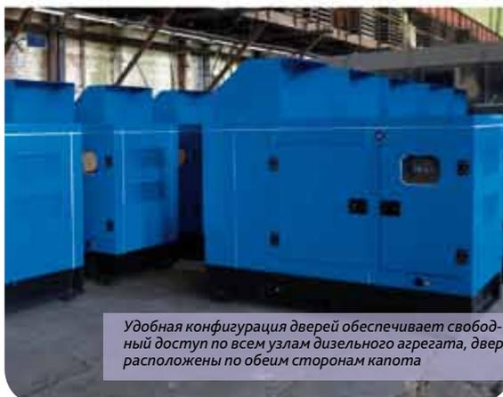
Удобная конфигурация дверей обеспечивает свободный доступ по всем узлам дизельного агрегата, двери расположены по обеим сторонам капота
