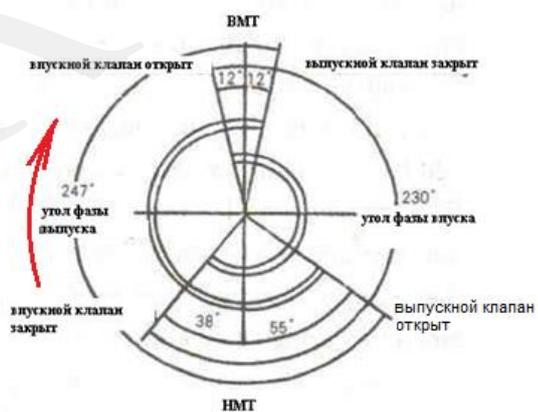
Рис.2. Углы открытия-закрытия клапанов
