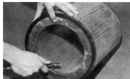
По окончании очистки проверьте фильтроэлемент на отсутствие повреждений. Осмотрите его снаружи. Установите проверочную лампу внутри фильтроэлемента и просветите его. Щели, разрывы, непрочности, деформация внешней или внутренней обечеек или другие повреждения не допускаются. При обнаружении указанных дефектов замените фильтроэлемент элемент.
